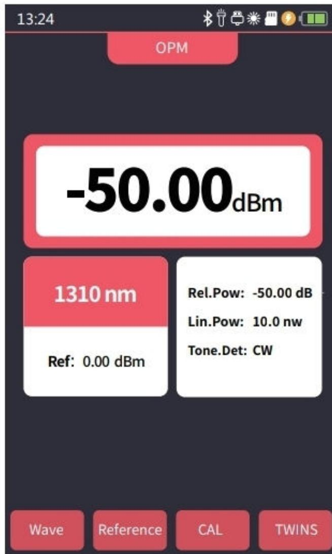
Das Funktion ist Gebraucht zu Prüfung das Energie von optisch Signal- und Einfügungsdämpfung verschiedener Geräte und photoelektrischer Komponenten. Es kann die Frequenz identifizieren und messen von 270/330/1000/2000Hz optisch Signal.
